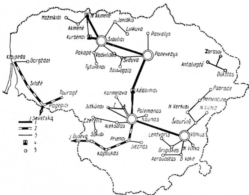
1959 metų Lietuvos energetikos sistemos 110 ir 35 kV tinklo schema: 1 – 110 kV ETL, 2 – 110 kV ETL, įjungtos 1960-11-8, 3 – 35 kV ETL, 4 – 110/35/10 kV transformatorinės pastotės, 5 – 35/10 kV transformatorinės pastotės
