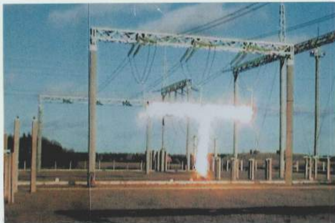
Trifazis trumpas jungimas Telšių 330 kV pastotėje ( Vaizdas praėjus 80 ms nuo t.j.)
