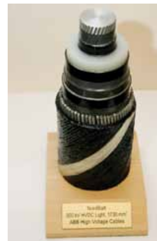
2-10 pav. „NordBalt“ jūrinis kabelis, jo skersmuo 123 mm, vienas metras sveria apie 30 kg, kabelio laidininką saugo 11 izoliacijos sluoksnių (74 mm) (Šaltinis: „Litgrid“)
