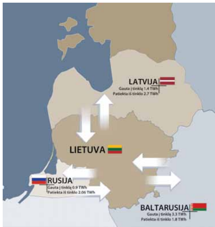
1-19 pav. Elektros energijos mainai su kaimyninėmis šalimis 2008 m. (Šaltinis: AB „Lietuvos energija“)
