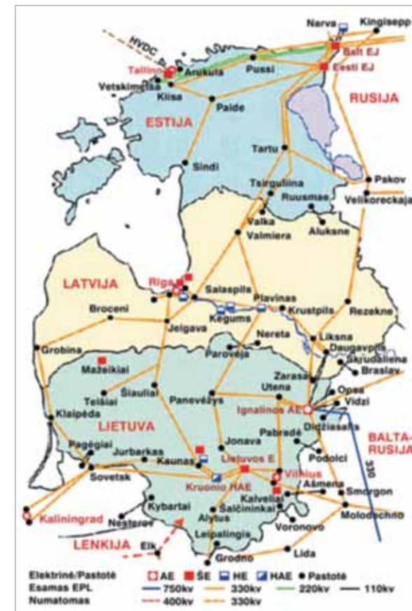
1-1 pav. Baltijos valstybių elektros perdavimo tinklų schema (Šaltinis: Nacionalinė energetikos strategija, 2002 m.)
