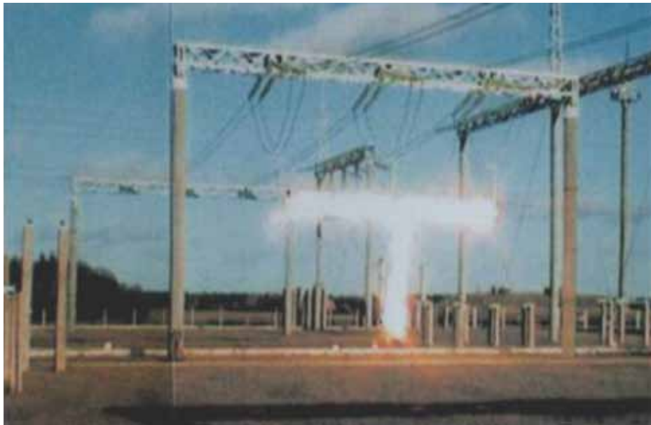
1-13 pav. Trumpojo jungimo bandymas Telšių 330 kV pastotėje. Vaizdas praėjus 80 ms nuo trumpojo jungimo
