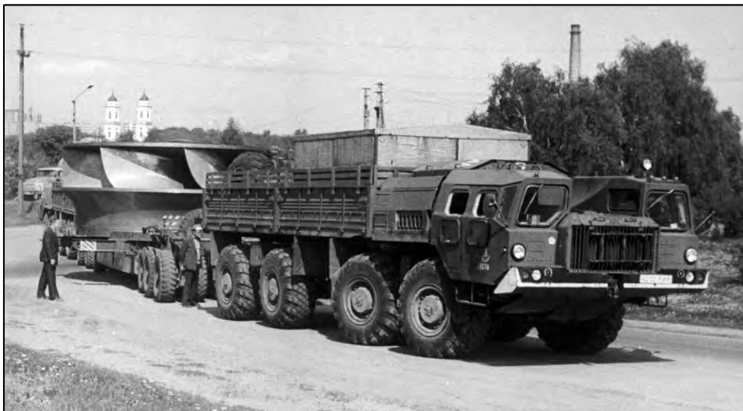
Kruonio HAE turbinos darbo rato, sveriančio 114 tonų, pervežimas iš Kauno į Kruonį dviem spec. vilkikais MAZ-7310 „Uragan“ (vienas traukia, kitas stumia), pagamintais Minsko automobilių gamykloje. 1989 m.
