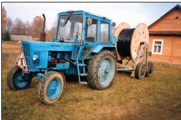
Elektros kabelis paruoštas išvežti į klojimo tranšėją
