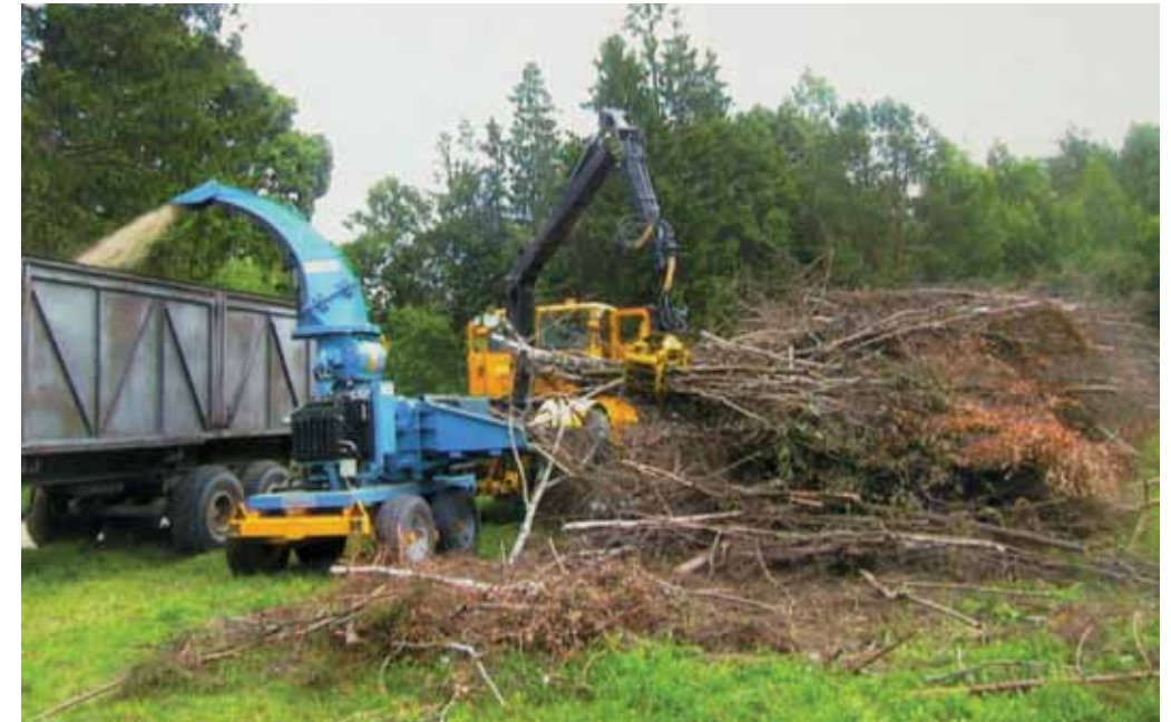
2 pav. Medienos kuro žaliavos smulkinimas būgniniu smulkintuvu „BRUKS 604 CT“ Rokiškio miškų urėdijoje
