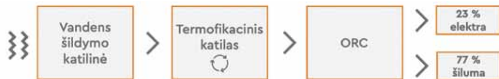
4 pav. ORC turbinos veikimo principas
