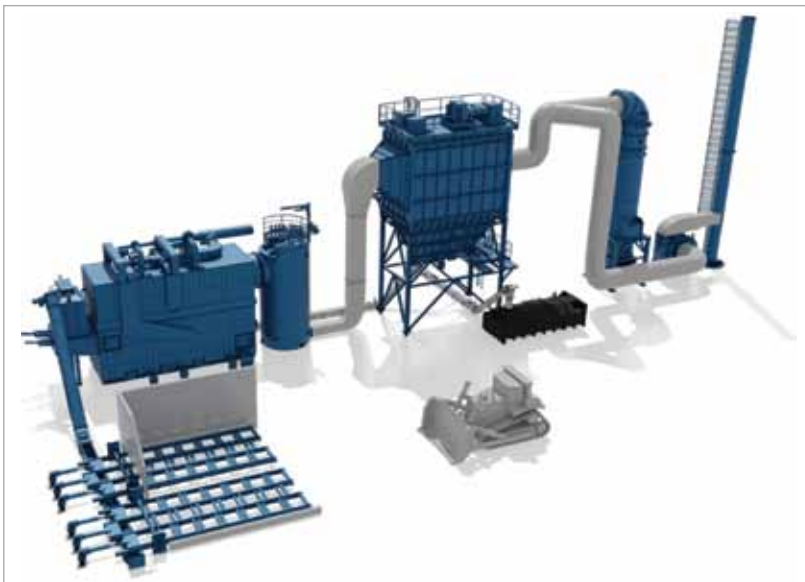
1 pav. Biomasės katilinės komplektacija
