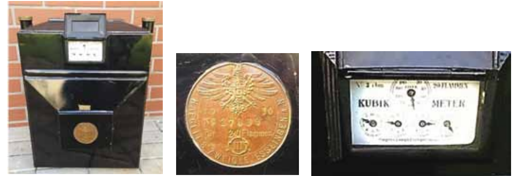
Klaipėdos dujų įmonėje naudotas, 1910 metų gamybos dujų skaitiklis (iš Regimanto Nausėdos kolekcijos)
