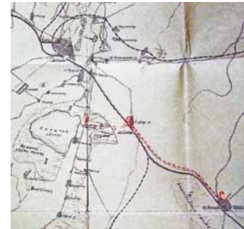
6 kV elektros tiekimo linijos Šilėnai–Radviliškis planas, 1927-04-20 (LCVA. F. 862, Ap.1, B. 715, L. 39)
