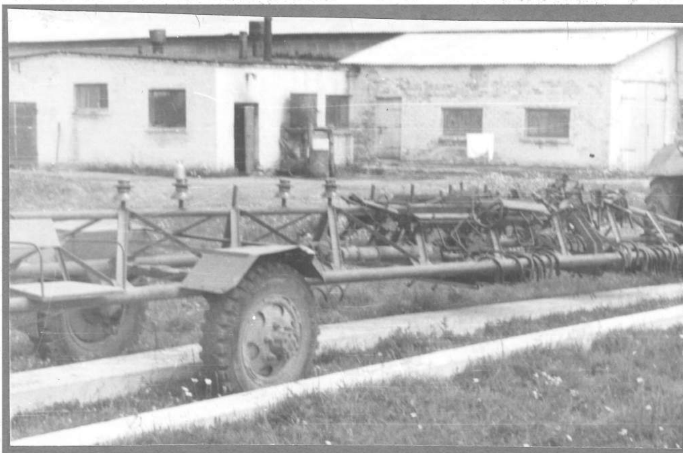
Priekaba atramų išvežimui trasoje (Racionalizatoriai E.Urbonaitė ir E. Drazdauskas).
